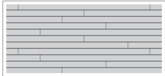
Vertikalfugen unregelmässig versetzt
